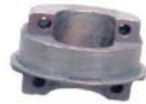
LH031 机型: MULLER III 名称: 压轴块 备注: D96×62E 国外编号: 325 388
